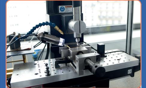
Le **micro-usinage** permet d'usiner des microstructures sur des plaques métalliques ou polymères pour la fabrication de puces en thermoplastiques (hot-embossing) ou en technologie PDMS
